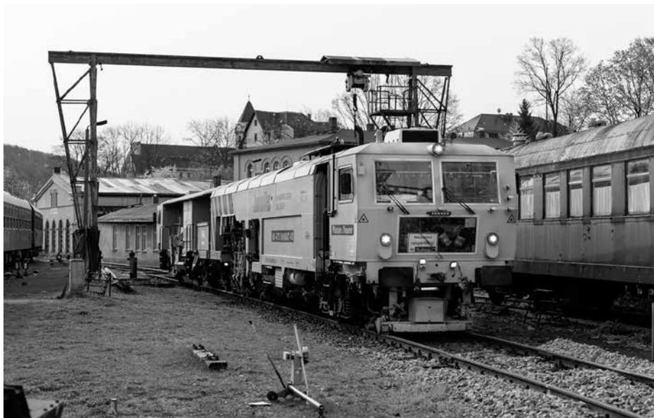
Der knapp 35 Meter lange beeindruckende Stopfzug hat in drei Durchgängen unser saniertes Gleis in die richtige Lage gebracht. (Foto: Bernd Hahn)
